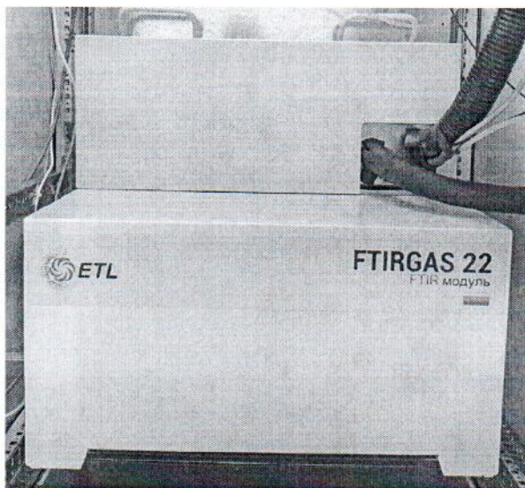
Рисунок 1 - Общий вид газоанализатора многокомпонентного FTIRGAS 22 модификации FTIRGAS 22 M-1 (допускается расположение фитингов подключения газовых линий на верхней панели измерительного модуля)
