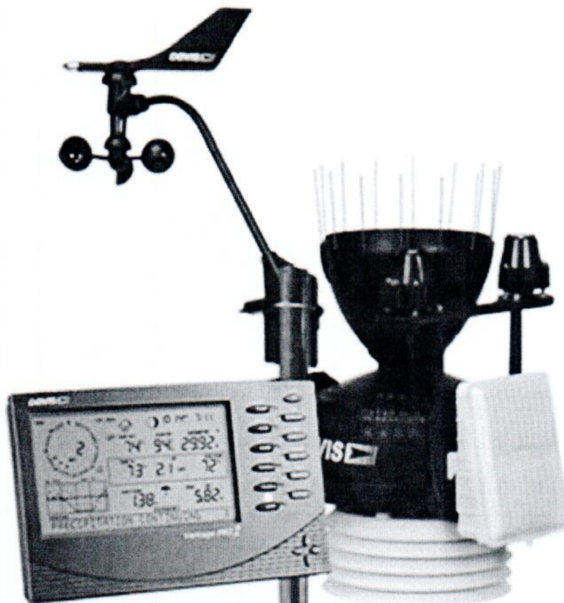
Рисунок 1.1 – Общий вид станции автоматической метеорологической Vantage Pro2 № BF21118009
