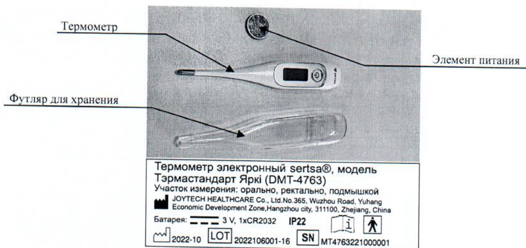
Рисунок 1.6 – Фотография общего вида термометра электронного Тэрмастандарт Яркі (DMT-4763) (изображение носит иллюстративный характер)
