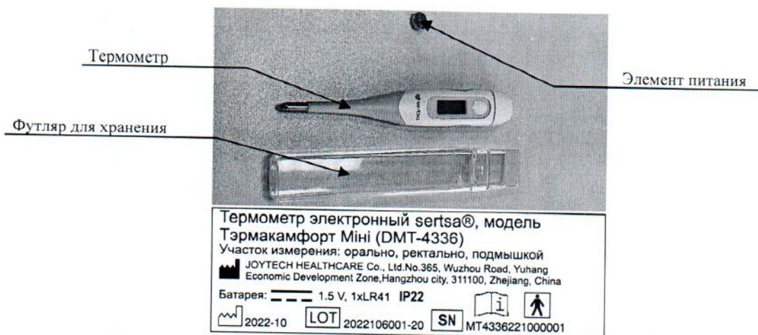
Рисунок 1.4 – Фотография общего вида термометра электронного Тэрмакамфорт Міні (DMT-4336) (изображение носит иллюстративный характер)
