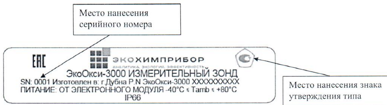
Рисунок 5 – идентификационная табличка анализаторов
