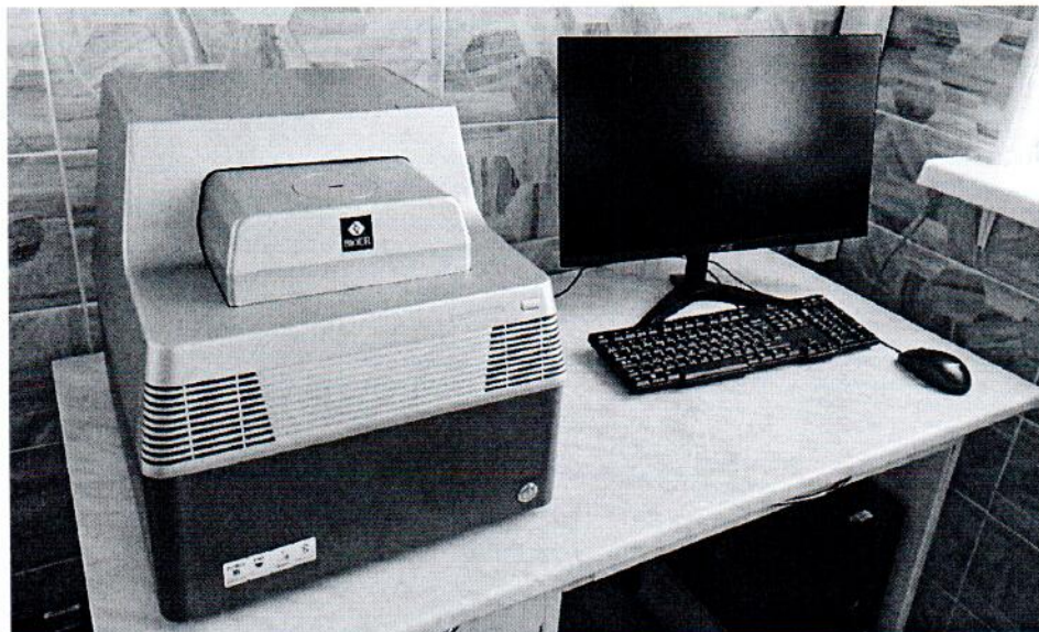
Рисунок 1.1 – Фотография общего вида амплификаторов для проведения полимеразной цепной реакции (ПЦР) с детекцией сигнала флуоресценции в режиме реального времени: амплификаторов в режиме реального времени Fluorescent Quantitative Detection System FQD-96A (изображение носит иллюстративный характер)
