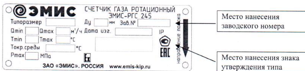
Рисунок 2 – Места расположения знака утверждения типа и заводского номера счетчика на маркировочной табличке
