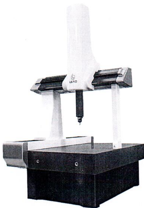
Рисунок 1.2 – Фотография общего вида координатно-измерительных машин Мастер Лайт (изображение носит иллюстративный характер)
