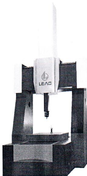
Рисунок 1.1 – Фотография общего вида координатно-измерительных машин Мастер ТОП (изображение носит иллюстративный характер)
