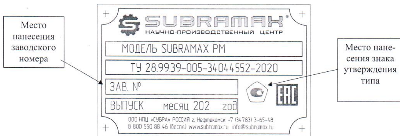
Рисунок 8 – Пример типовой идентификационной таблички
