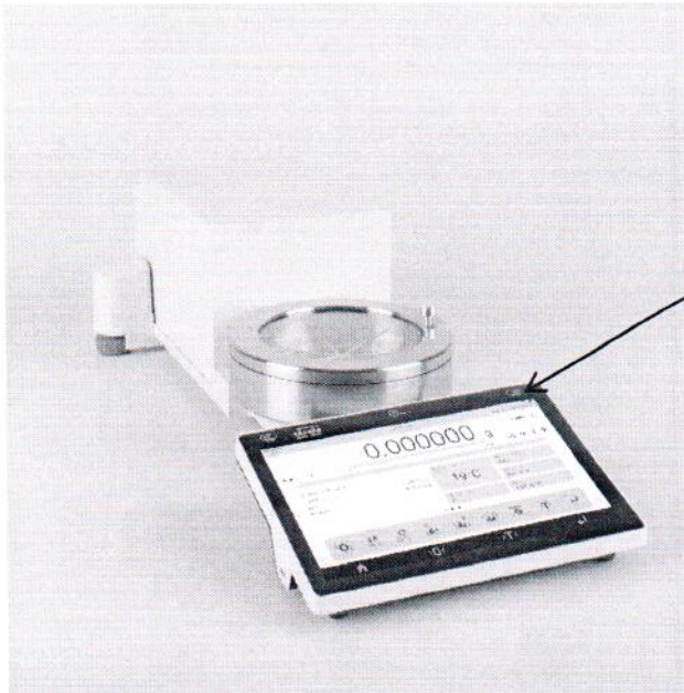
Рисунок 2.1 – Схема (рисунок) с указанием места для нанесения знаков поверки на весы
