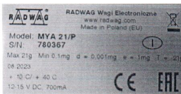
Рисунок 1.4 – Маркировка весов лабораторных МYA (изображение носит иллюстративный характер)
