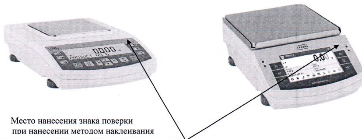
Рисунок 2.1 – Схема (рисунок) с указанием места для нанесения знаков поверки на весы
