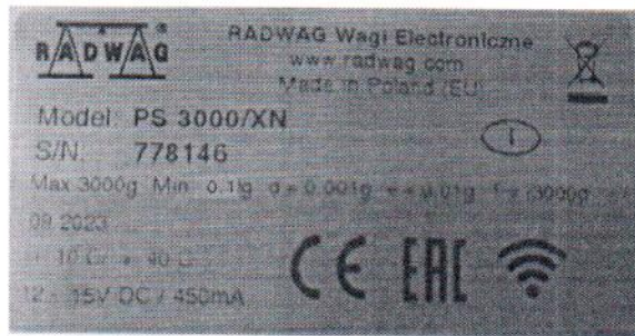
Рисунок 1.4 – Маркировка весов лабораторных (изображение носит иллюстративный характер)
