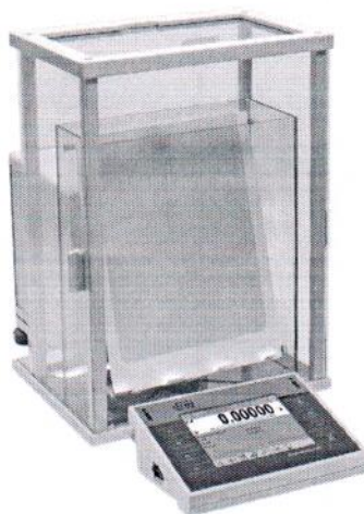
Рисунок 1.8 – Фотография общего вида весов лабораторных электронных ХА с индексами «4Y», «F» в обозначении модификации
