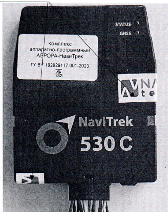
Рисунок 3.1 – Схема пломбировки от несанкционированного доступа
