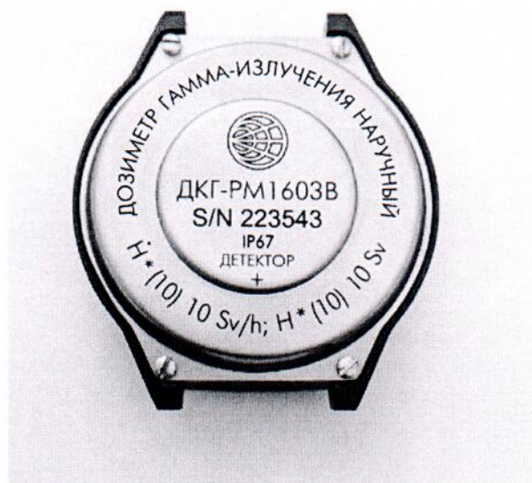
Рисунок 1.2 – Фотография маркировки дозиметров (изображение носит иллюстративный характер, дата изготовления указывается в руководстве по эксплуатации в разделе «Свидетельство о приемке»)
