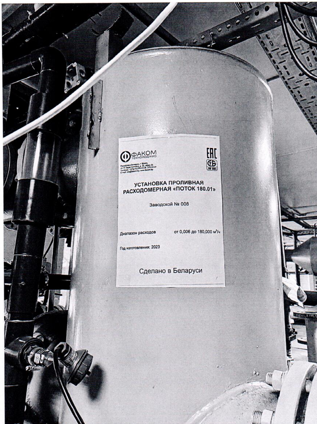
Рисунок 1.2 – Фотография маркировки установки проливной расходомерной «Поток 180.01» № 008
