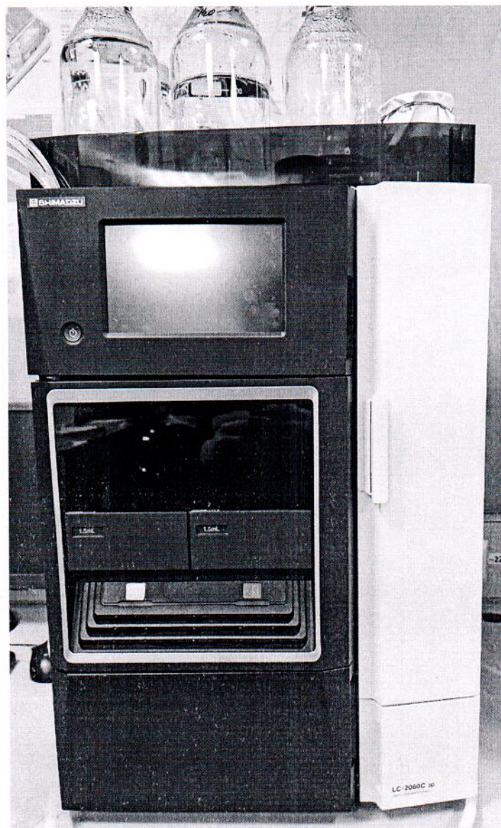
Рисунок 1.1 – Фотография общего вида хроматографа жидкостного высокоэффективного с диодно-матричным детектором LC-2060C 3D № L23016000181 AE
