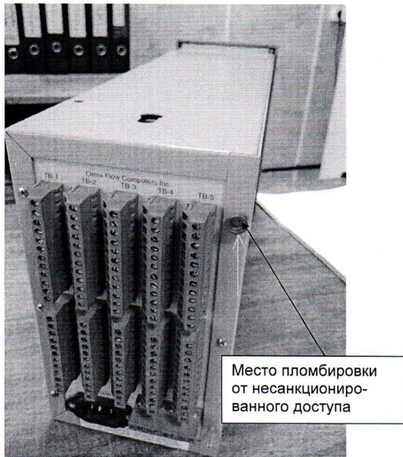
Рисунок 3.2 – Место пломбировки на задней поверхности
