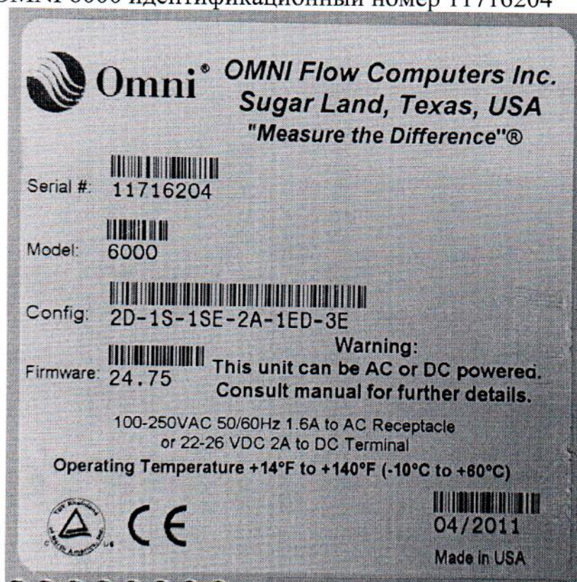
Рисунок 1.2 – Маркировка контроллера измерительно-вычислительного OMNI 6000 идентификационный номер 11716204
