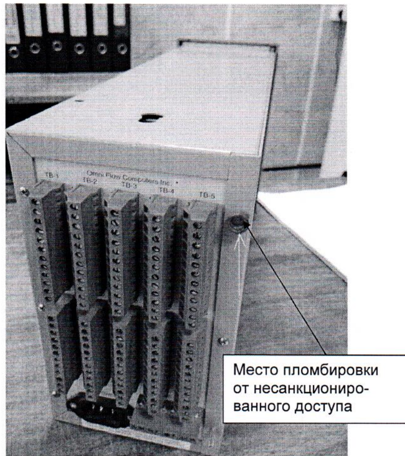
Рисунок 3.2 – Место пломбировки на задней поверхности
