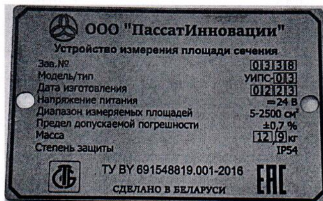
Рисунок 1.3 – Фотография маркировки УИПС (изображение носит иллюстративный характер)
