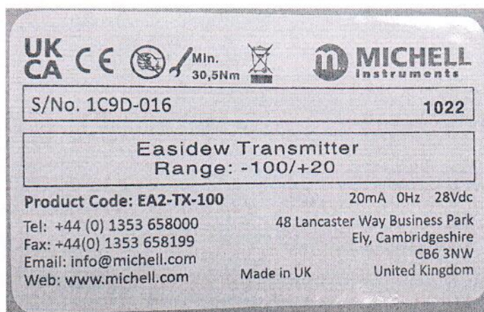
Рисунок 1.2 – Маркировка преобразователя температуры точки росы/иней Easidew Transmitter № 1C9D-016
