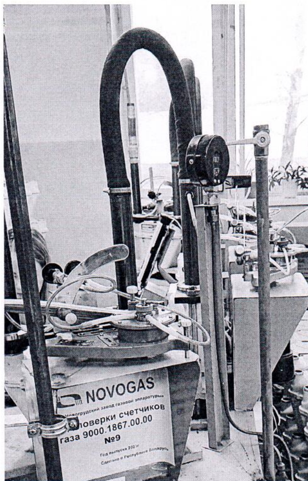
Рисунок 1.1 – Фотографии общего вида стенда поверки счетчиков газа 9000.1867.00.00 № 9
