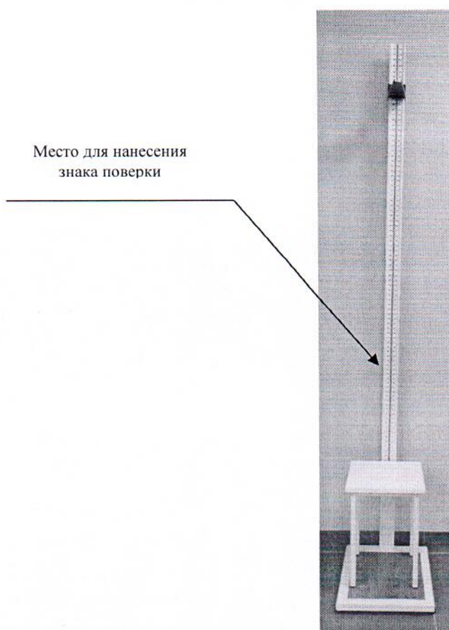
Рисунок 2.1 – Схема (рисунок) с указанием места для нанесения знака поверки для ростометров медицинских РМ-1П
