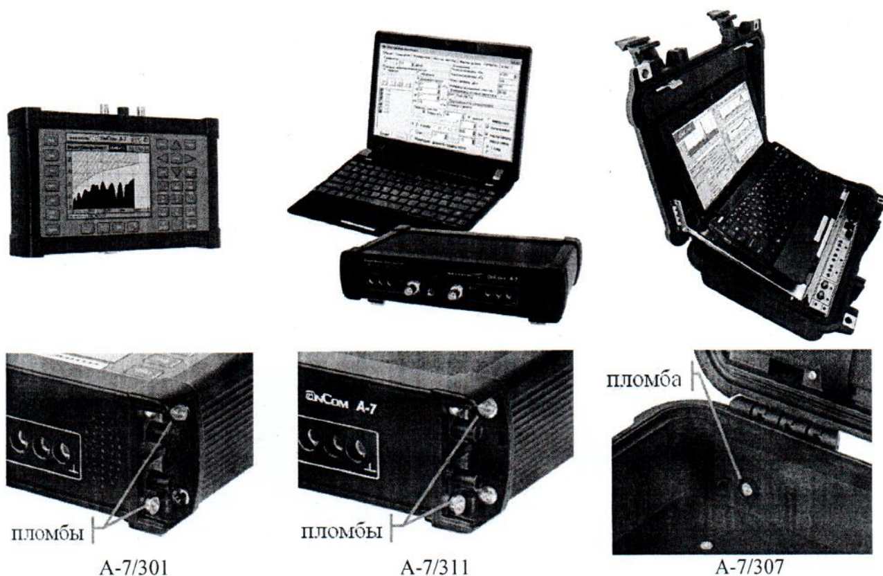
Рисунок 1 – Внешний вид и пломбирование анализаторов
