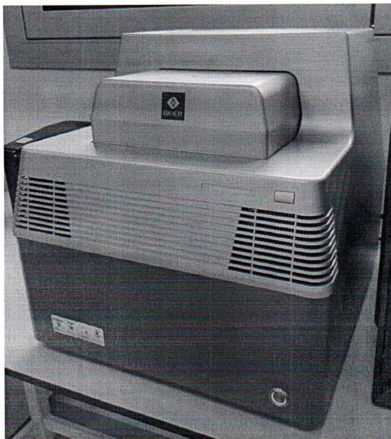
Рисунок 1.1 – Фотография общего вида амплификатора для проведения полимеразной цепной реакции (ПЦР): амплификатора в режиме реального времени LineGene 9600 Plus Fluorescent Quantitative Detection System FQD-96A(EA5) № BYQ6A94E-550970
