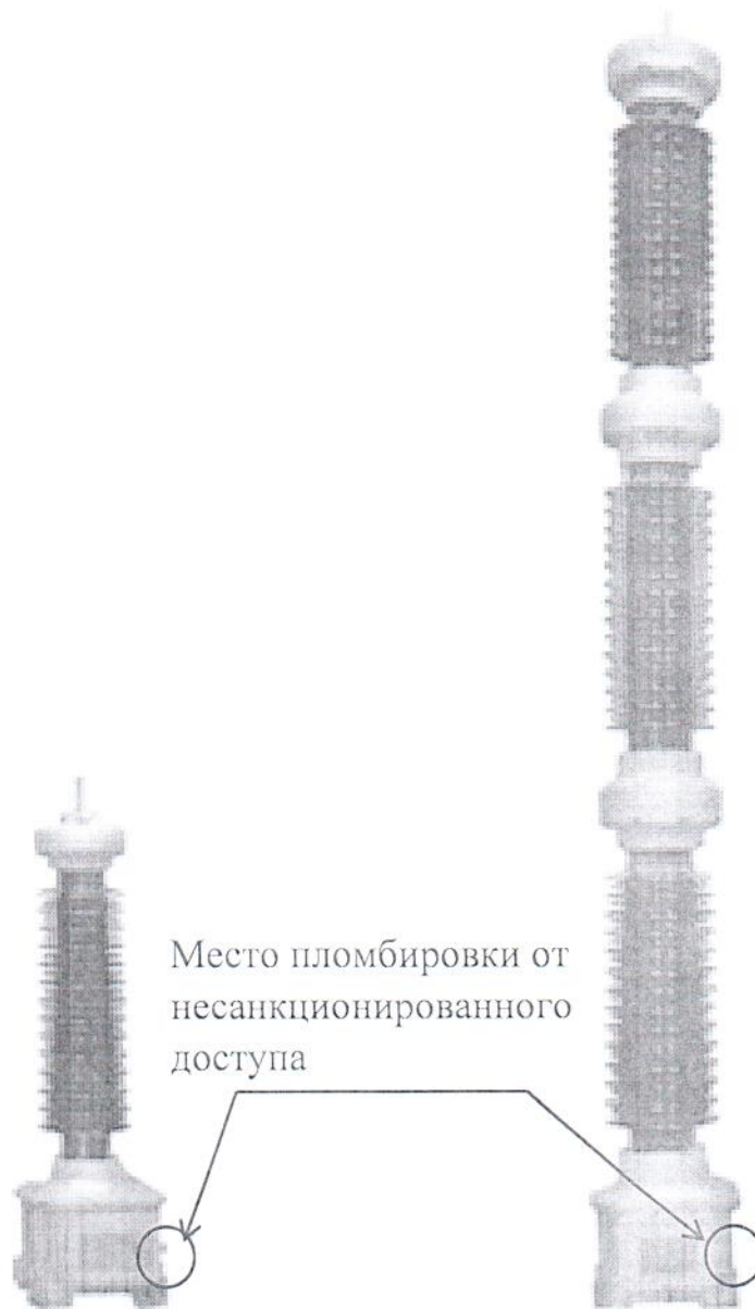
Рисунок 3.1 - Схема пломбировки от несанкционированного доступа
