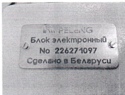
Рисунок 1.3 – Маркировка преобразователя АТ, преобразователя ЦТ, блока электронного актинометра ПЕЛЕНГ СФ-12-21 (изображения носят иллюстративный характер)
