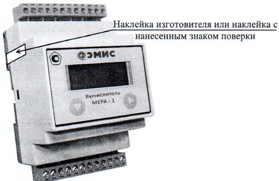
Рисунок 4 - Схема пломбировки вычислителя счетчиков раздельного исполнения
