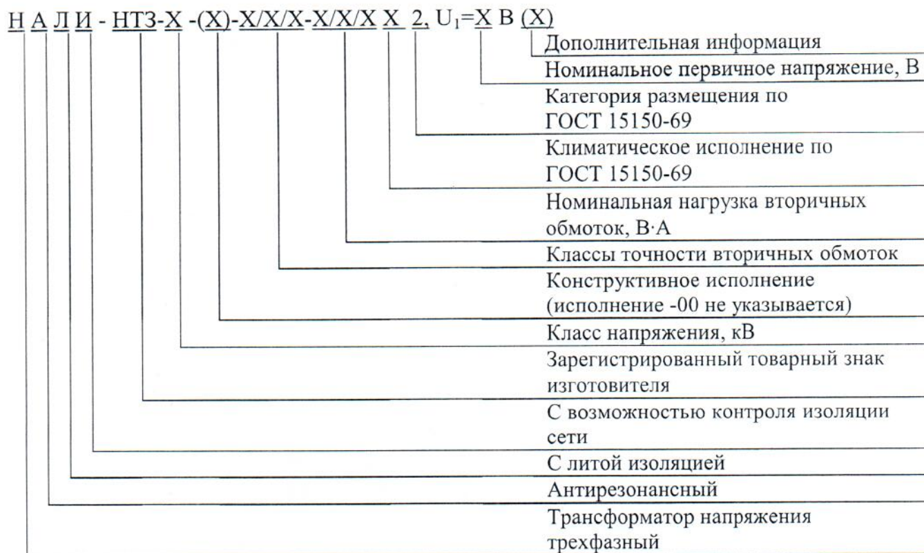
Рисунок 4 – Структура условного обозначения трансформаторов напряжения НАЛИ-НТЗ
