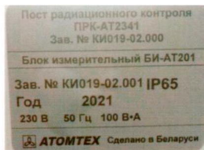
Рисунок 1.3 – Фотография маркировки ПРК-АТ2341 (изображение носит иллюстративный характер, дата изготовления указывается в руководстве по эксплуатации в разделе «Свидетельство о приемке»)
