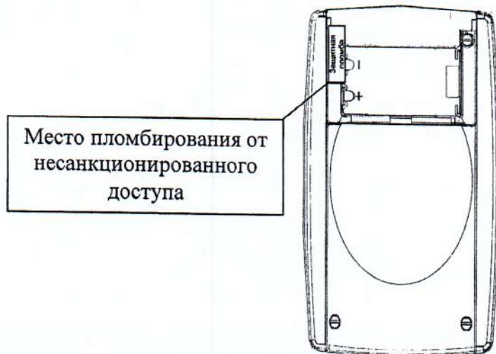
Рисунок 1 - Схема пломбирования от несанкционированного доступа
