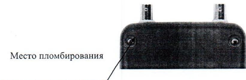
Рисунок 1 - Место нанесения пломбировки от несанкционированного доступа на панели электронного блока приборов модификаций ПУЛЬСАР-2.1, ПУЛЬСАР-2.2
