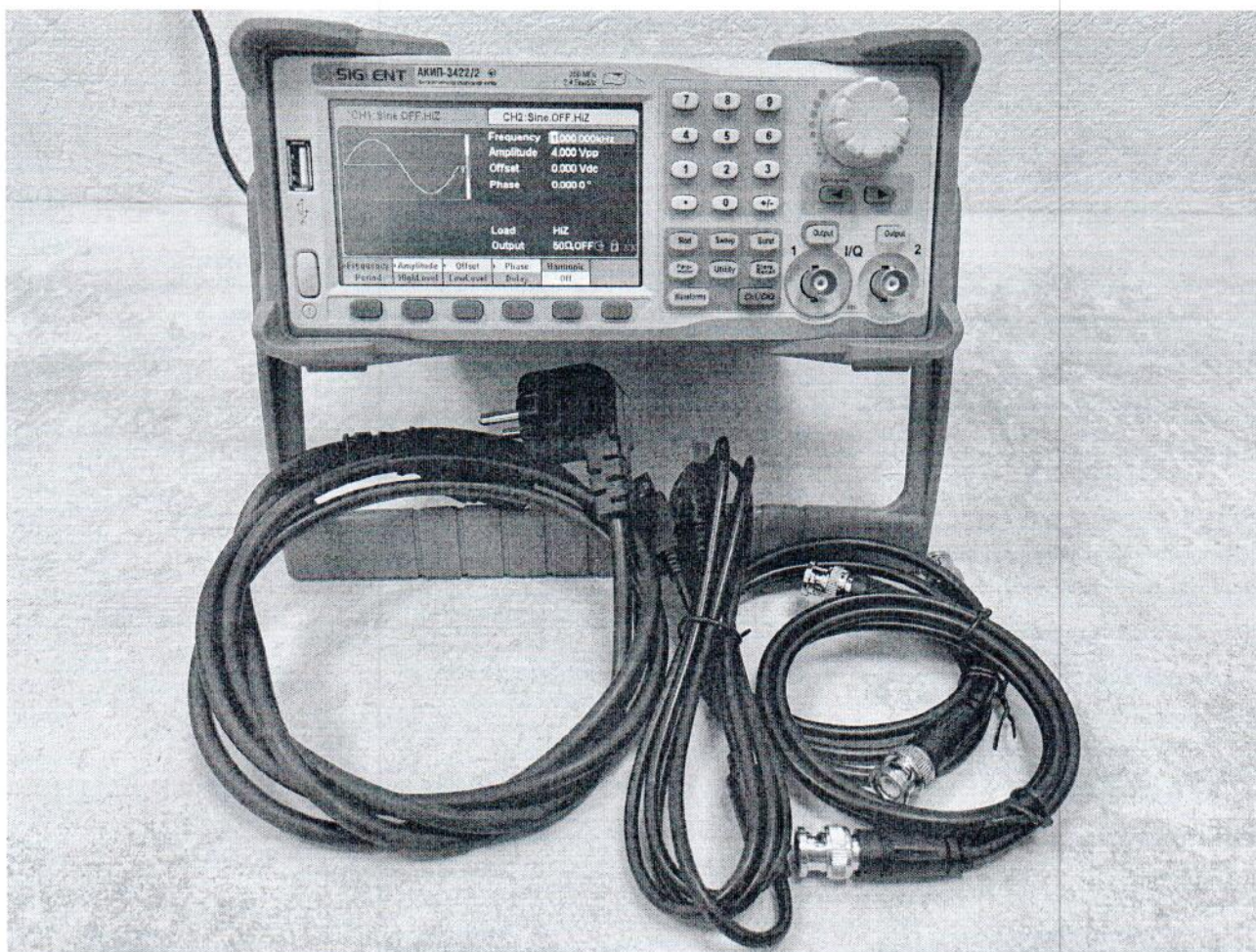
Рисунок 1.1 – Фотография общего вида генератора сигналов специальной формы АКИП-3422/2 № SDG6XFCQ6R0481
