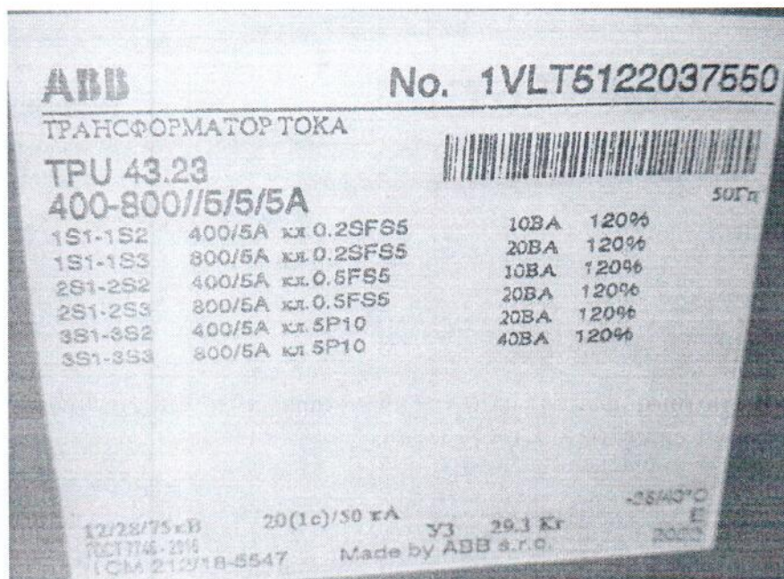
Рисунок 1.2 – Фотография маркировки трансформатора тока TPU 43.23 № 1VLT5122037550
