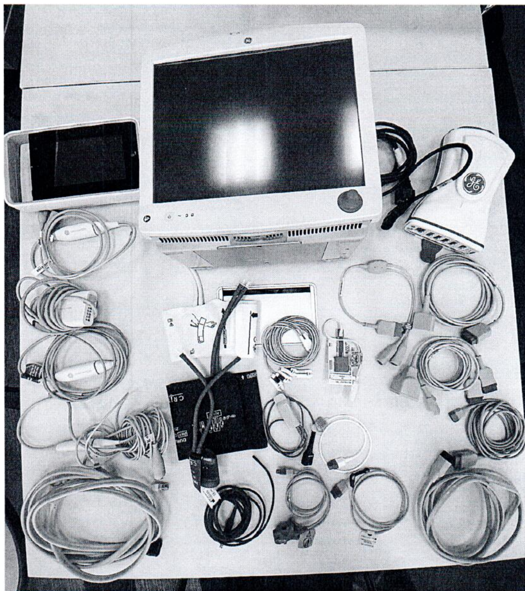
Рисунок 1.3 – Фотография общего вида монитора пациента CARESCAPE B650 (изображение носит иллюстративный характер)
