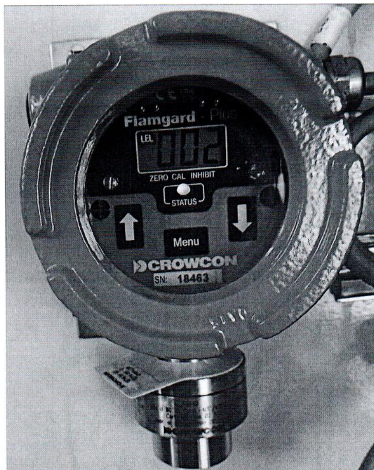
Рисунок 1.1 – Фотография общего вида газоанализатора горючих газов стационарного Flamgard Plus № 18463
