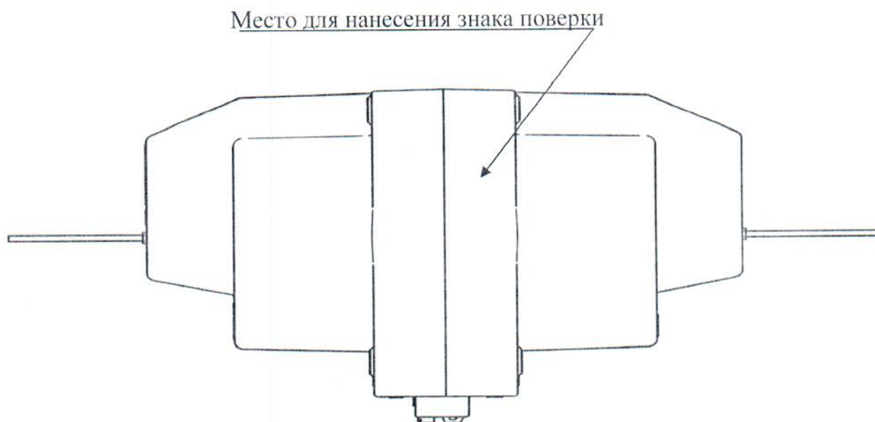
Рисунок 2.1 – Схема (рисунок) с указанием места для нанесения знака поверки трансформаторов тока ТТЛ-10 на номинальные первичные токи от 5 до 250 А
