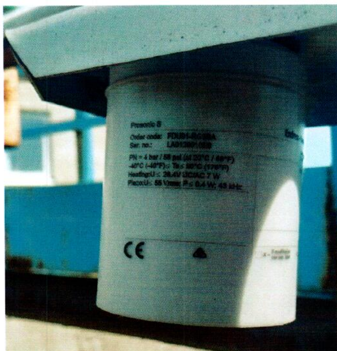
Рисунок 1.3 – Фотография общего вида первичного преобразователя FDU91-RG3BA № LA0129010E8 уровнемера ультразвукового PROSONIC входящего в состав узла учета (основной комплект)
