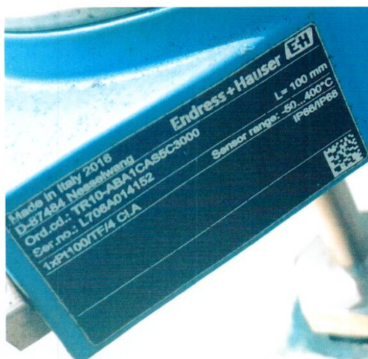
Рисунок 1.6 – Фотография маркировки термопреобразователя сопротивления Omnicard TR10-ABA1CAS5C3000 № L706A014152 входящего в состав узла учета (основной комплект)
