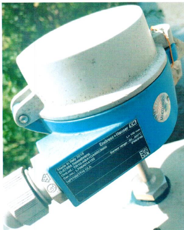
Рисунок 1.5 – Фотография общего вида термопреобразователя сопротивления Omnicard TR10-ABA1CAS5C3000 № L706A014152 входящего в состав узла учета (основной комплект)
