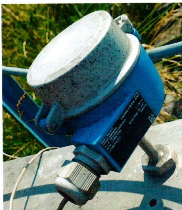
Рисунок 1.5 – Фотография общего вида термopреобразователя сопротивления Omnigrad TR10-ABA1CAS5C3000 № L7069E14152 входящего в состав узла учета (основной комплект)
