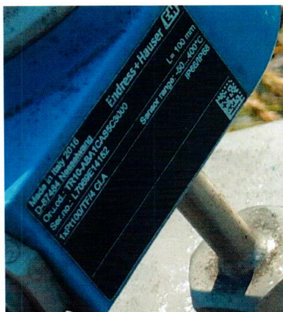
Рисунок 1.6 – Фотография маркировки термopреобразователя сопротивления Omnigrad TR10-ABA1CAS5C3000 № L7069E14152 входящего в состав узла учета (основной комплект)
