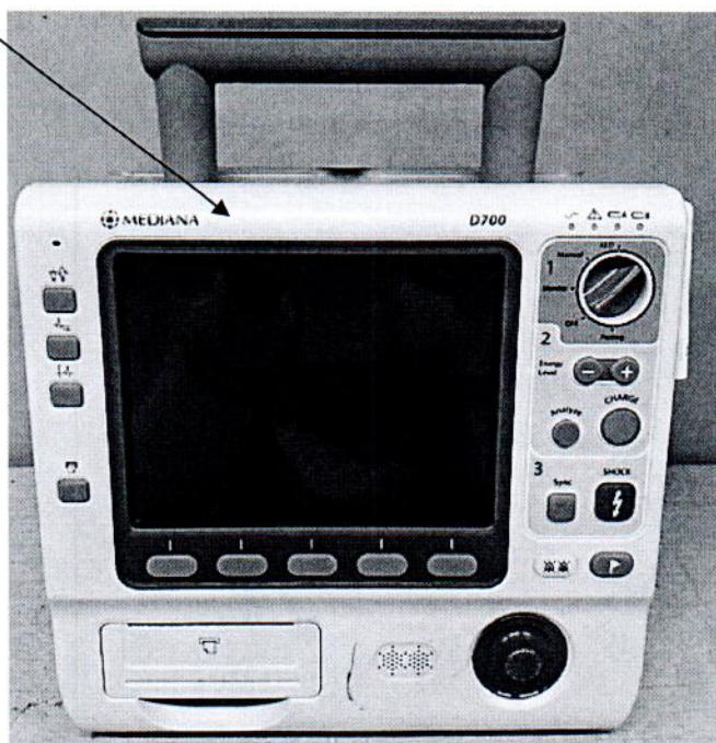
Рисунок 2.2 – Схема (рисунок) с указанием места для нанесения знака поверки на дефибриллятор-монитор Mediana D700
