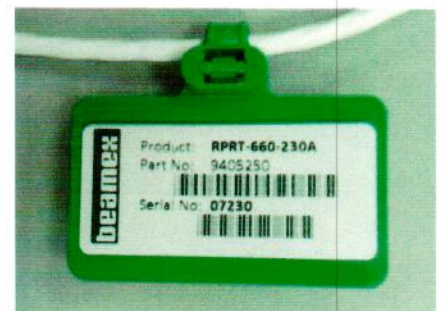
Рисунок 1.4 – Фотографии общего вида и маркировки внешних термопреобразователей сопротивления повышенной точности из комплекта калибраторов (изображение носит иллюстративный характер)
