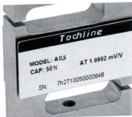
Рисунок 1 - Пример маркировки датчика силы
