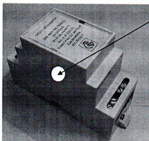
Рисунок 3 – Внешний вид и место нанесения знака поверки в виде клейма-наклейки преобразователей в корпусе Д
