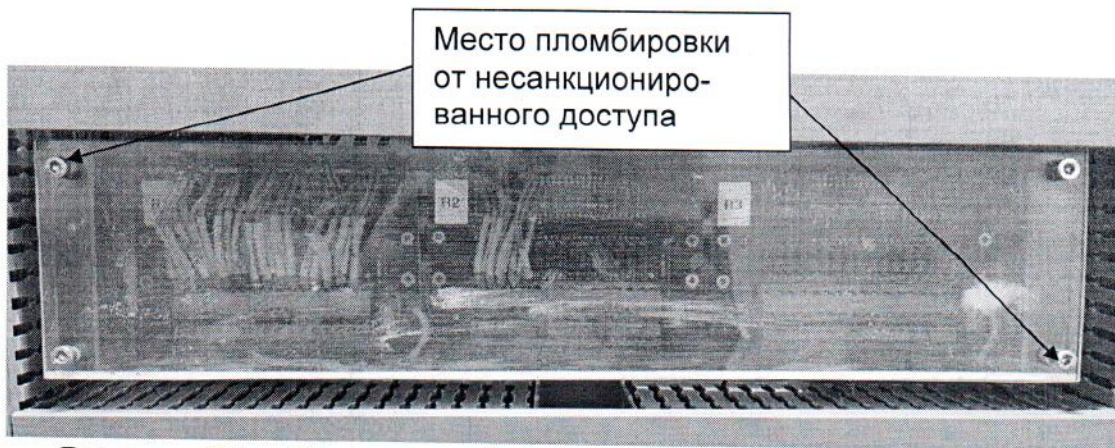
Рисунок 3.3 – Места пломбировки модуля токовых сигналов АИН-Р
