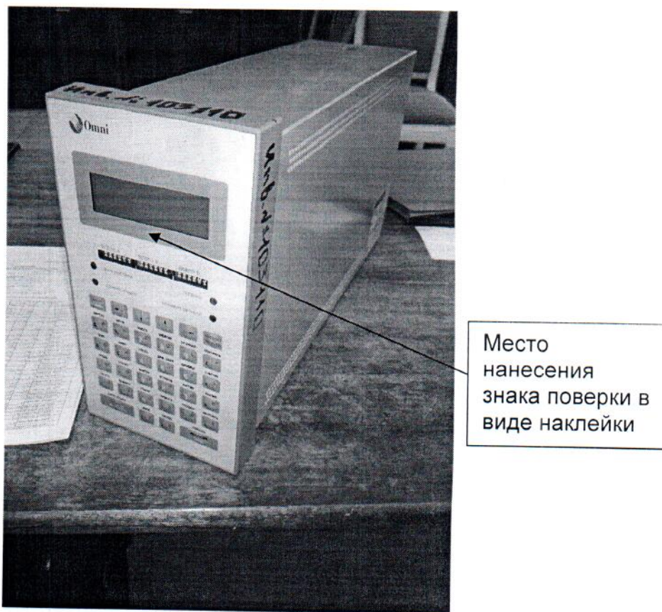
Рисунок 2.1 – Схема с указанием места нанесения знака поверки методом наклеивания
