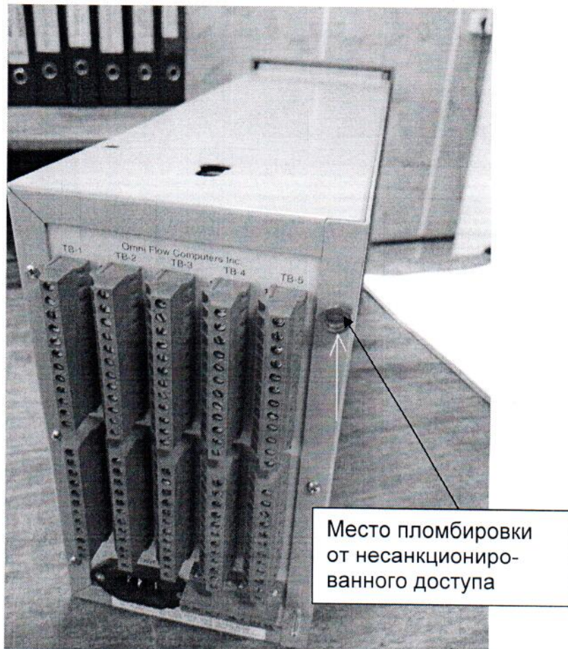
Рисунок 3.2 – Место пломбировки на задней поверхности
