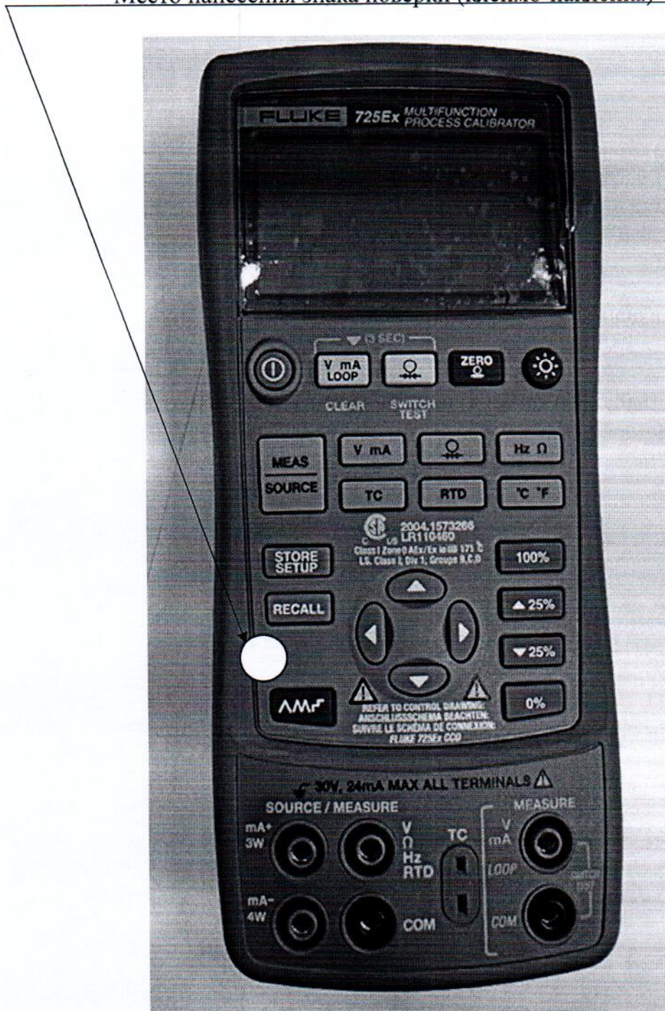
Рисунок 2 – Место для нанесения знака поверки в виде клейма-наклейки
