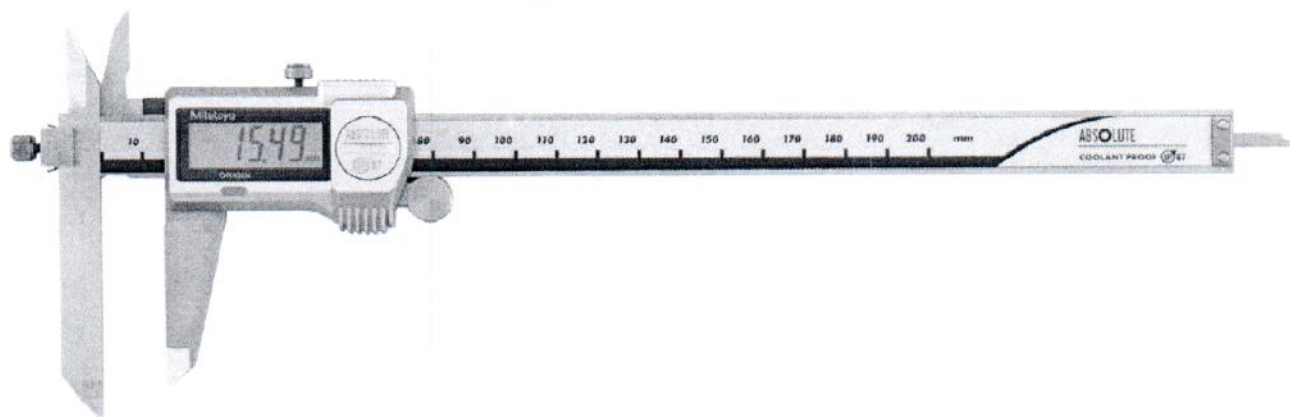
Рисунок 15.3 – Внешний вид штангенциркуля Absolute Digimatic серии 573 с регулируемой губкой
