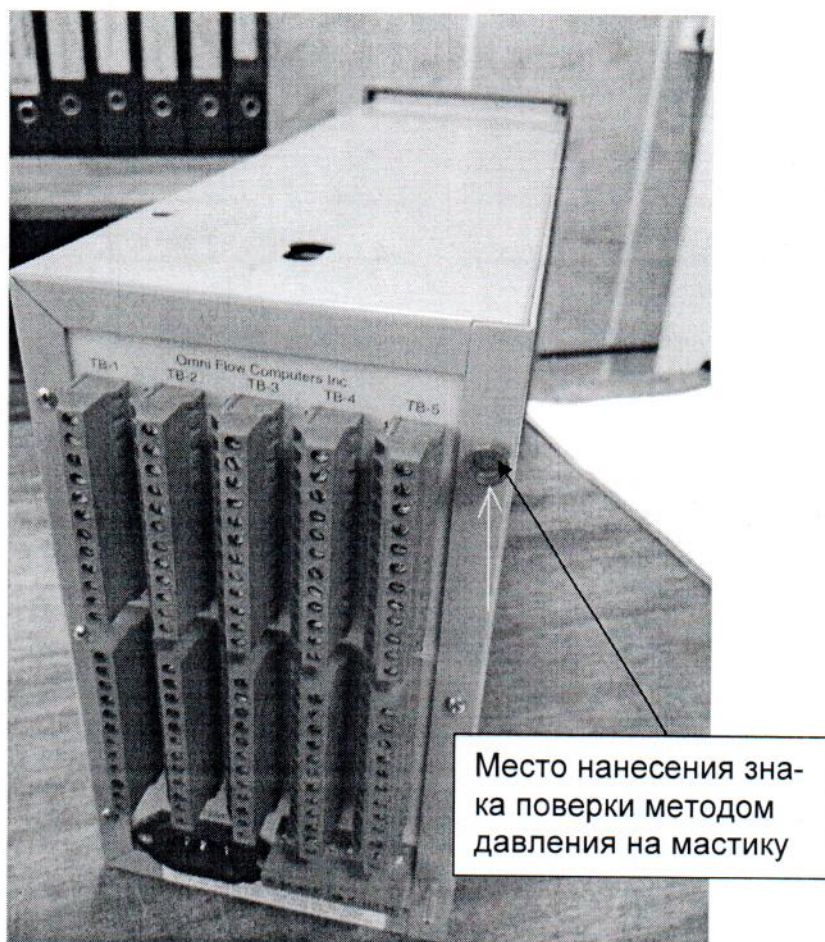
Рисунок 3.2 – Место пломбировки на задней поверхности
