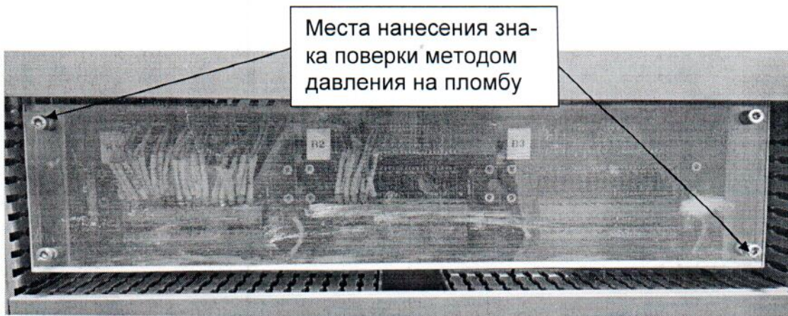
Рисунок 3.3 – Места пломбировки модуля токовых сигналов AIN-R
