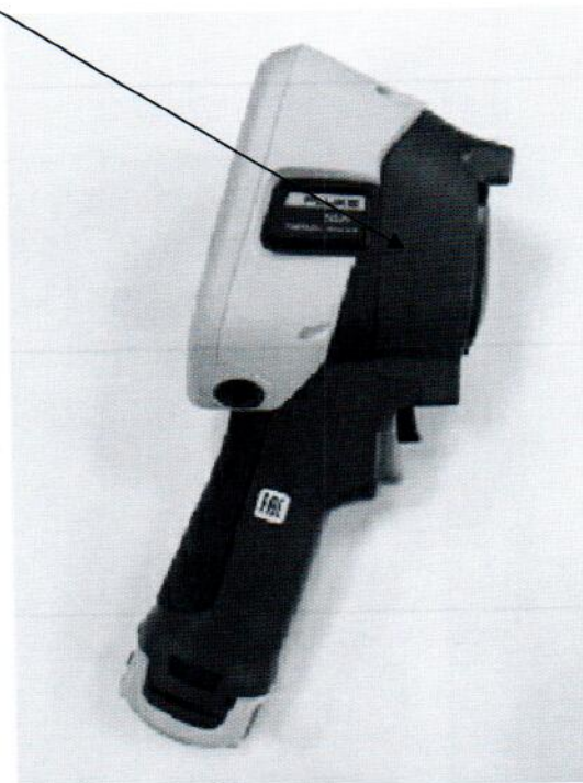
Рисунок 2.1 – Схема (рисунок) с указанием места для нанесения знака поверки на камеры тепловизионные Fluke серии Ti
