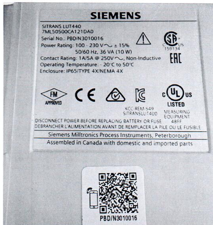
Рисунок 1.2 – Фотография маркировки уровнемера ультразвукового SITRANS LUT 440 № PBD/N3010016 входящего в состав узла учета
