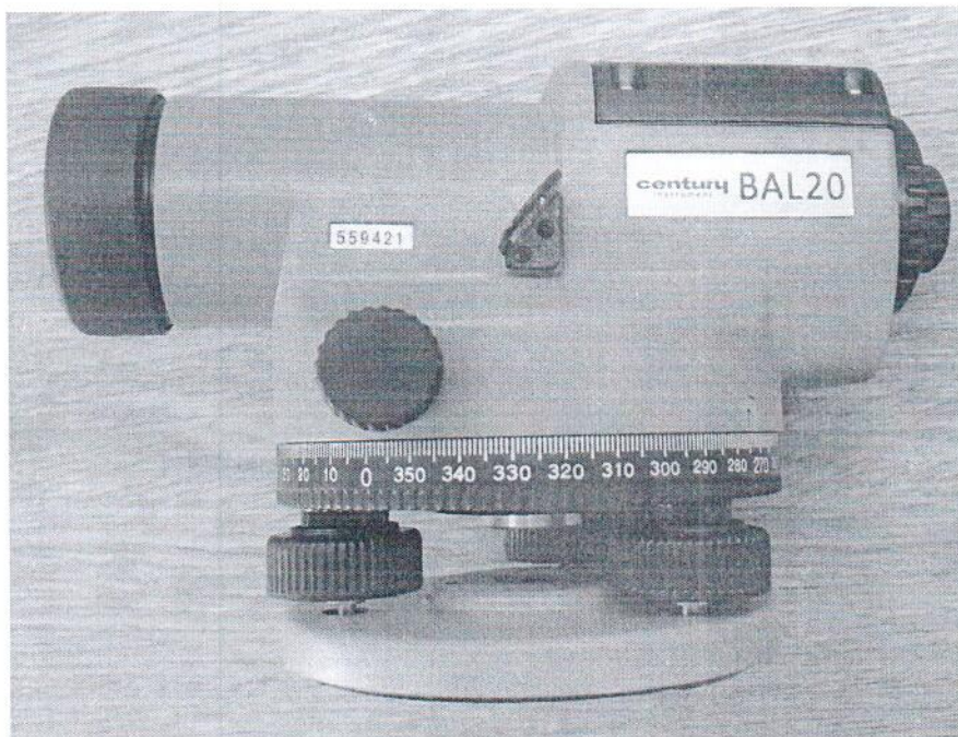
Рисунок 1.1 – Фотография общего вида нивелиров оптических BAL (изображение носит иллюстративный характер)
