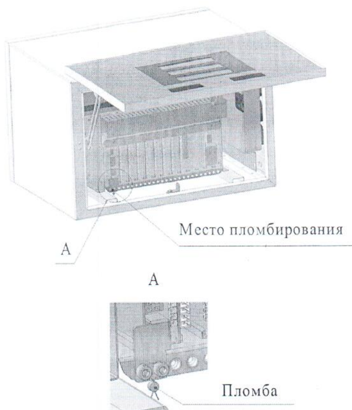
Рисунок 15 - Контроллер КМК. Схема пломбирования от несанкционированного доступа Программное обеспечение
